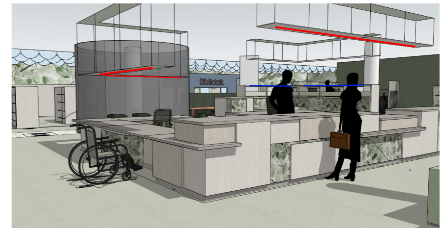
Placeringar av armaturer ovan disk. Underlag för elposition. Röda dikt undersida hylla och blå väggmontage, se sorter i armaturförteckning för annan entreprenad.
